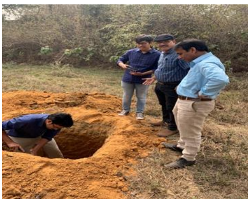
चित्र 4.6 सिंचित कमांड क्षेत्र में मिट्टी प्रोफाइल अध्ययन और मिट्टी नमूना संग्रह
